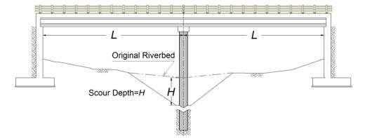
Fig. 11 Definition of parameter H
