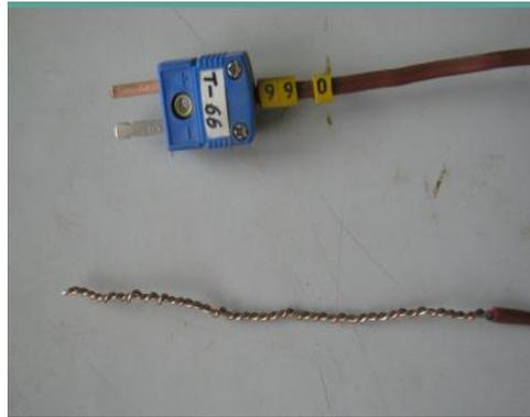
Fig. 7 Thermocouple
