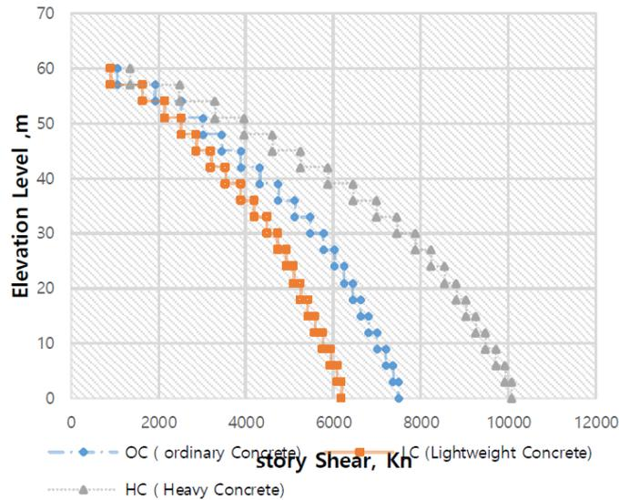
Fig. 8 Story shear, kn
