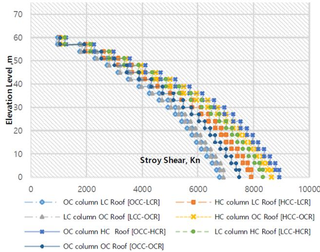
Fig. 16 Story shear, kn
