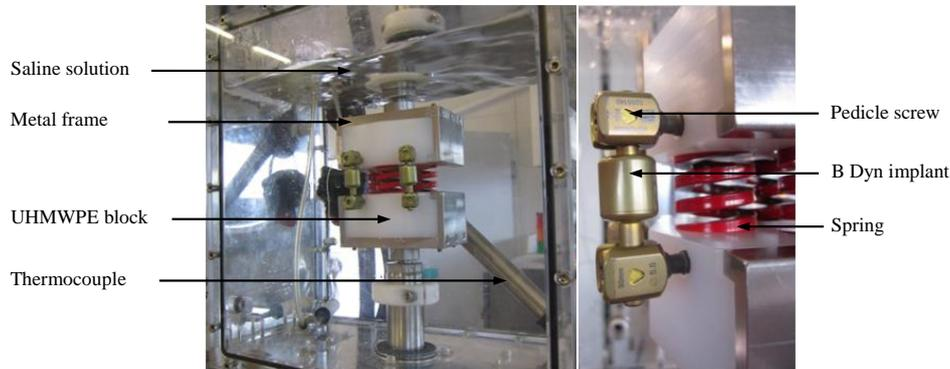
Fig. 2 Fatigue test apparatus
