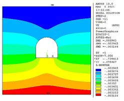
(d) Displacement in Y direction after support
