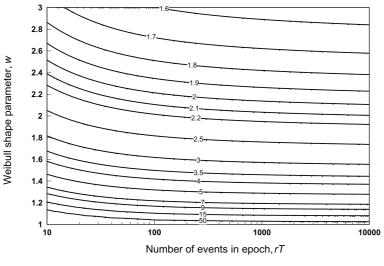
Fig. 4 GEV limit ratio,  $V_{\rm lim}/V_{\rm mode}$
