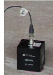
(b) Accelerometer DH610V
