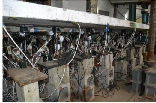
Fig. 5 LVDTs
