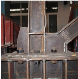
(d) Buckling occurred at column base
