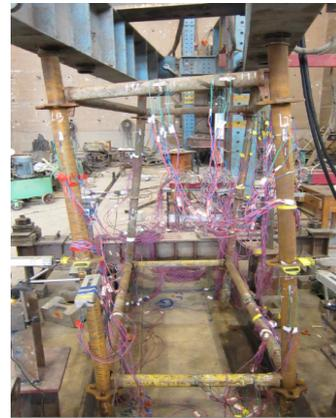
(d) Buckling mode of specimen 4
