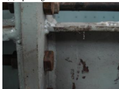
(d) Buckling of Beam Top Flange
