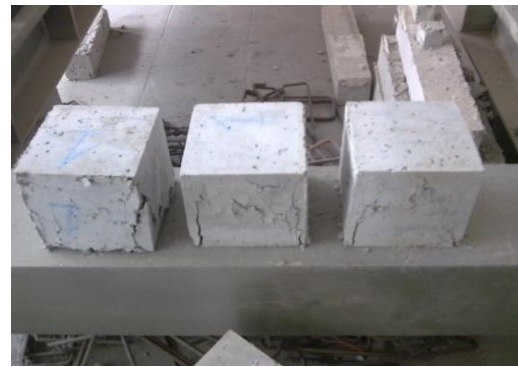
(d) Polypropylene fibre concrete specimens after Pressure
