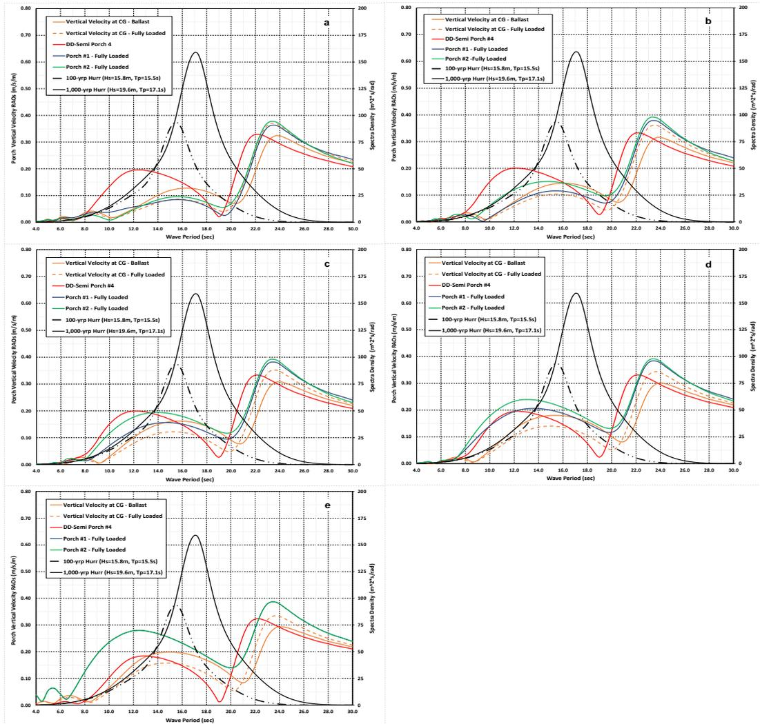
Fig. 20 The PVV RAOs: (a) 180 deg, (b) 150 deg, (c) 135 deg, (d) 120 deg and (e) 90 deg headings
