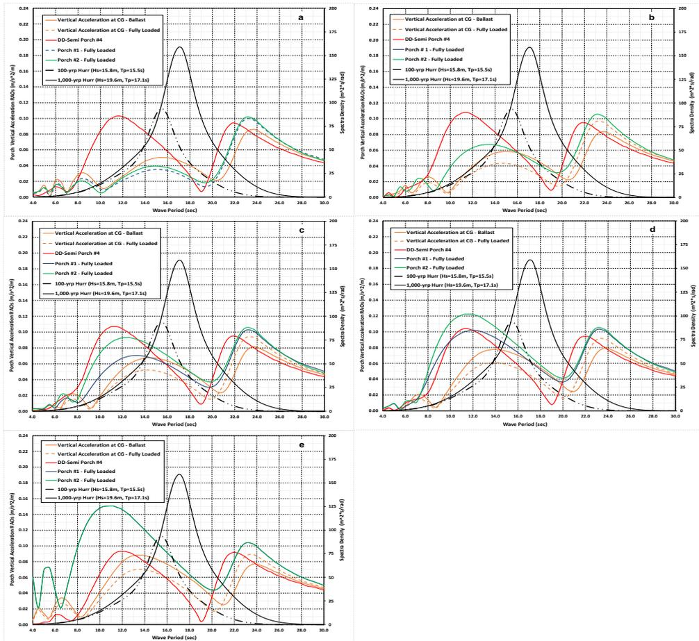
Fig. 21 The PVA RAOs: (a) 180 deg, (b) 150 deg, (c) 135 deg, (d) 120 deg and (e) 90 deg headings
