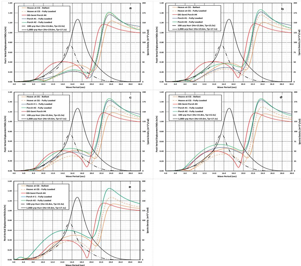
Fig. 19 The PVD RAOs: (a) 180 deg, (b) 150 deg, (c) 135 deg, (d) 120 deg and (e) 90 deg headings
