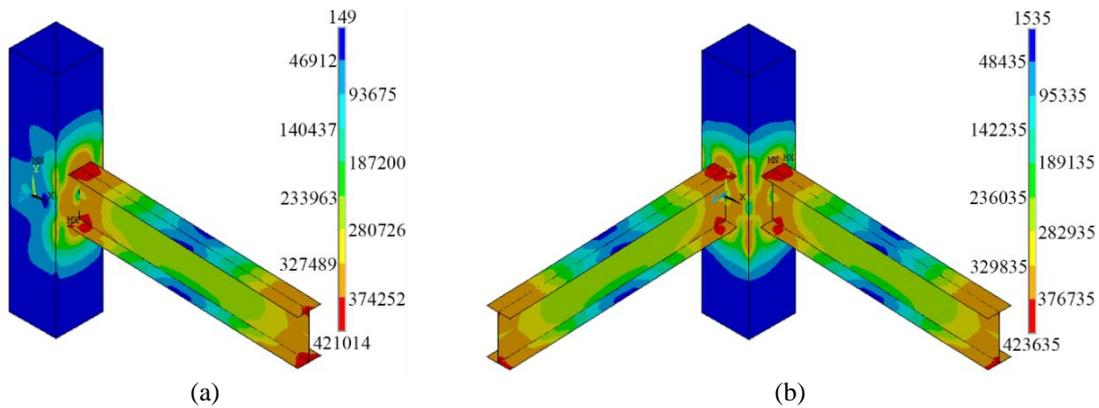
Fig. 10 von Miss stresses for (a) M7-U; (b) M7-M
